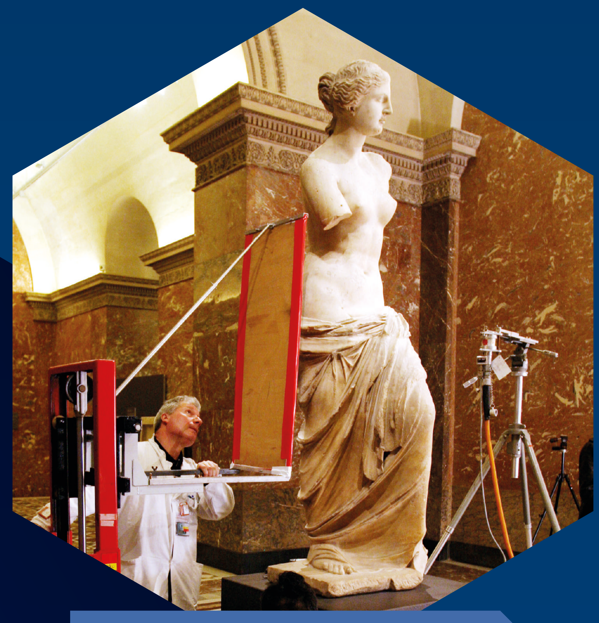
La Vénus de Milo est exposée aux rayons, à l'aide d'un gammagraphe, qui révéleront les fragilités de son anatomie.
