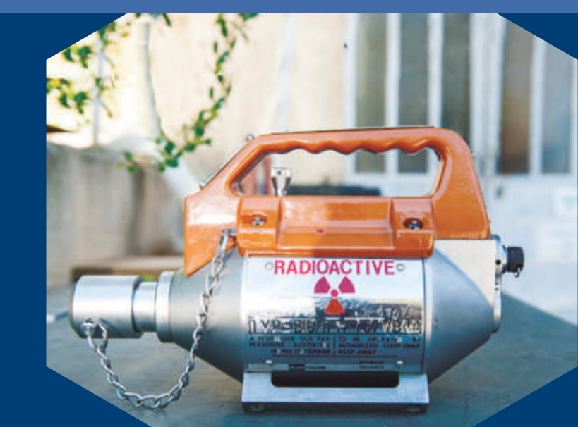
La Vénus de Milo est exposée aux rayons, à l'aide d'un gammagraphe, qui révéleront les fragilités de son anatomie.
